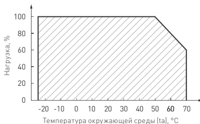
Рис. 2. Максимальная допустимая нагрузка, % от мощности источника.
